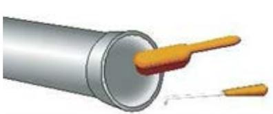
Contrôle et nettoyage de l'intérieur de la tulipe, du logement du joint.
